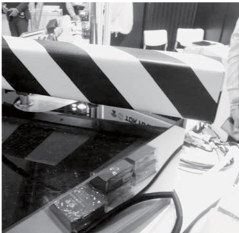
非接触近接センサーを組み込んだバンパー
